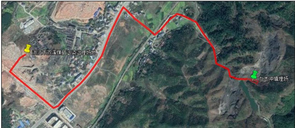
图3.5-5 建筑垃圾转运路线图
